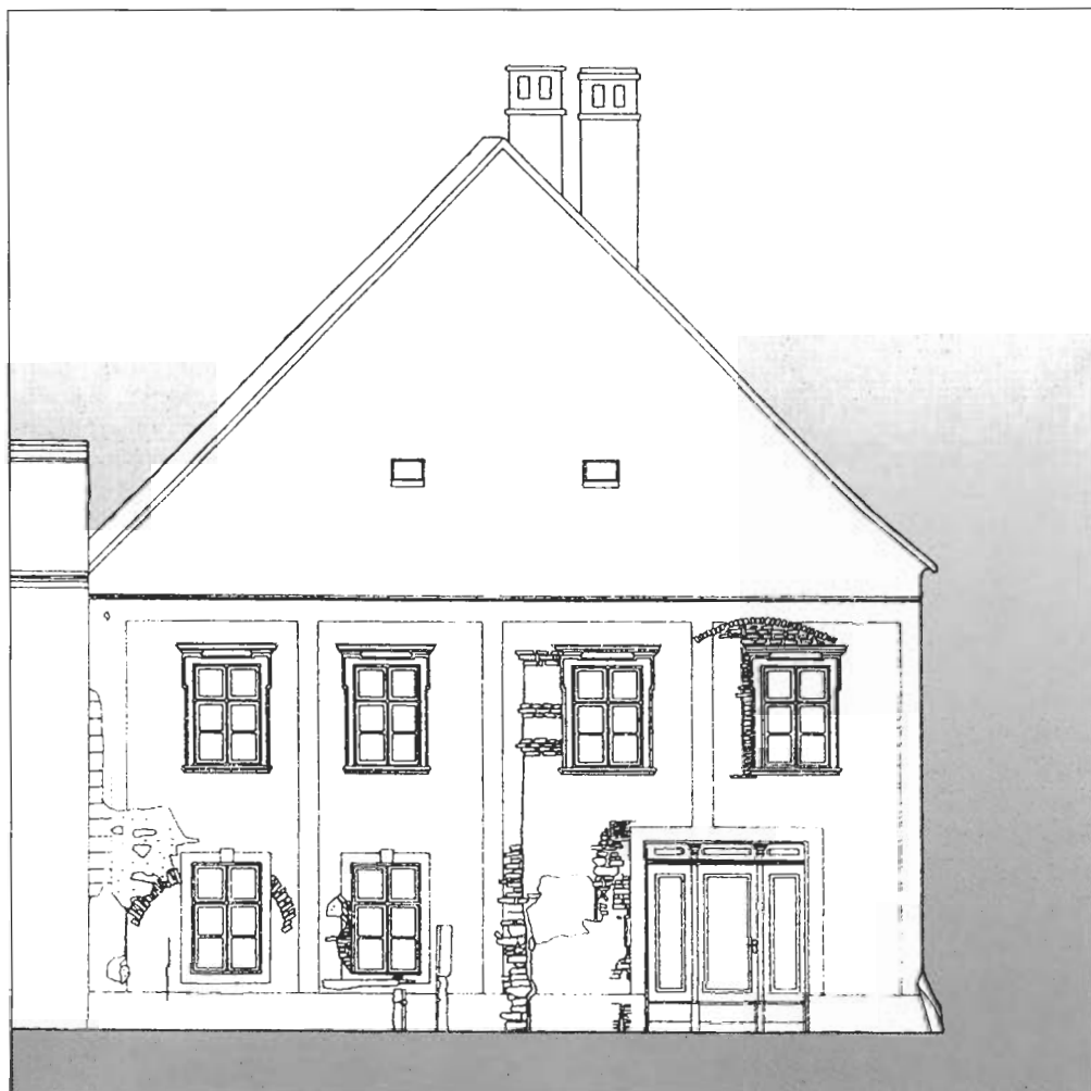
A Jurisics tér felőli homlokzat felmérési rajza a falkutatás eredményével Rajz: P. Samu Viktória The survey drawing of the facade with the result of the wall-research Drawing by Viktória P. Samu
