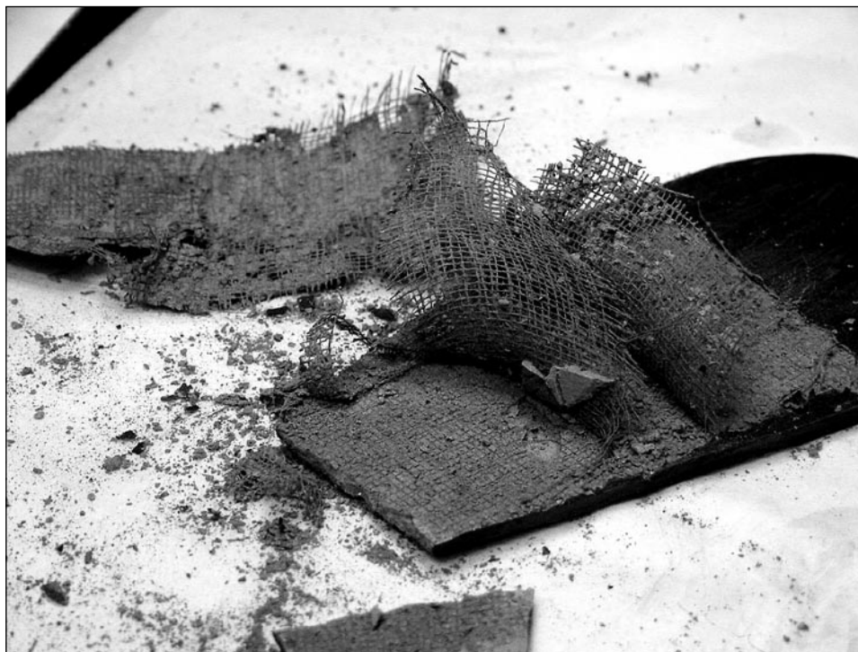
A veret hátoldalán lévő rétegek The layers on the back of the mounts Fotók – Photos: T. Bruder Katalin
